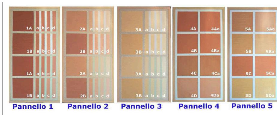
**Tavelloni** - Il catalogo dei colori di tipo “fisso” è stato realizzato su tavelloni in laterizio (25x50x5 cm) che sono stati prima intonacati con calce idraulica naturale e poi utilizzati per la stesura delle cromie.
